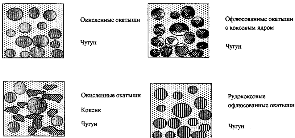
Рис. 3.1. Основные исследованные виды синтикома с оксидным и углеродистым наполнителями.
